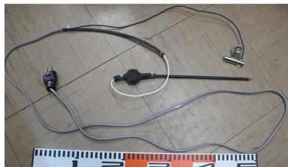
写真3 中型動物用の電極棒と電極クリップ
